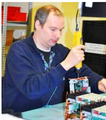
Am Werkstisch in der GWE montieren Mitarbeiter wie Wolfgang Schrader täglich 1.800 Autoradios vor
